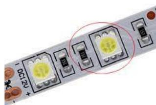
Fig.3: LEDstrip avec résistance
